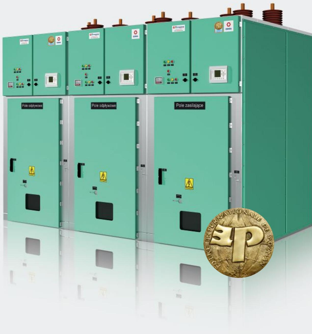
**ODRA** - Система КРУ высокого напряжения для промышленной энергетики. КРУ с выкатным элементом и выделенными отсеками, с наибольшим рабочим напряжением до 36 (40,5) кВ и номинальным током до 4000 А
